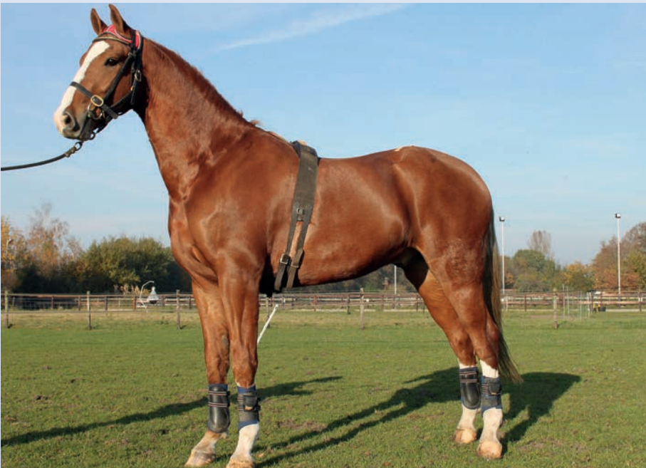
Met sensoren onder andere onderaan de benen kan Inertia overbelasting bij paarden meten.
